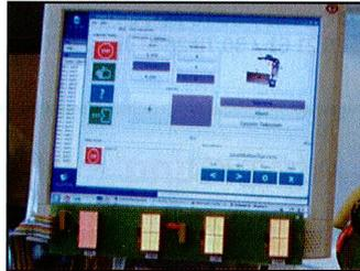
**Bildschirm, über den die in einer speziellen Situation möglichen Befehle zur Robotersteuerung durch den Nutzer angezeigt werden. Hier mit einer Erweiterung zur Nutzung einer Brain-Computer-Schnittstelle.**
