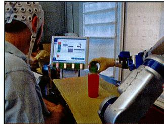
**Blinkende Leuchtdioden zur Steuerung des Roboters mittels SSVEP angebracht am Bildschirm.**
